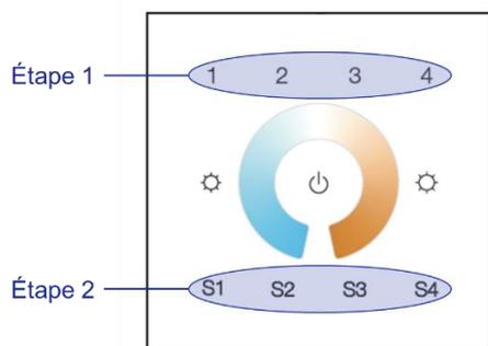
Il est nécessaire de réaliser l'appairage / paramétrage d'une zone (cf. chapitre 4.1.2) avant de paramétrer une scène.
