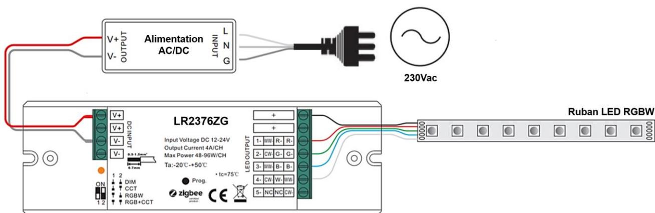
\*Il est nécessaire de vérifier que la tension de sortie de l'alimentation AC/DC correspond à celle du produit d'éclairage. Pour cet exemple, régler les interrupteurs du récepteur sur ON pour le switch 1 et OFF le switch 2 afin de configurer votre système.
